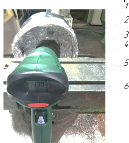
Рис. 3. Стенд для испытания конформной системы охлаждения композитной формообразующей детали пресс-формы: 1 – изолированный короб; 2 – металлическая обойма; 3 – металлополимерная формообразующая; 4 – гибкие трубопроводы системы охлаждения; 5 – тиски; 6 – фен промышленный
