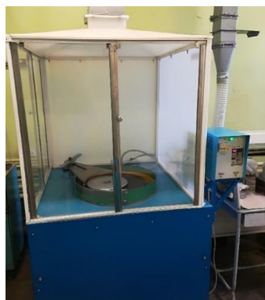
Рис. 1. Наклеенные на планшайбу керамические образцы (слева), установка по обработке сверхтвердых материалов (справа)
