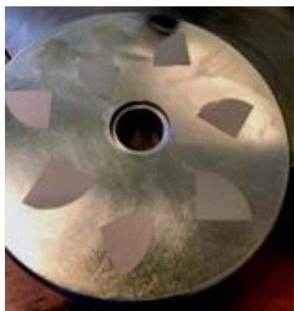
Рис. 1. Наклеенные на планшайбу керамические образцы (слева), установка по обработке сверхтвердых материалов (справа)
