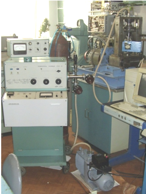
Рис. 4. Установка для нормализованного метода определения влияния технологии на герметичность неподвижных соединений
