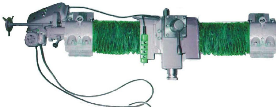
Рис. 4. Универсальный встраиваемый станок УВС-01 (А.С. №1306648) [23]
