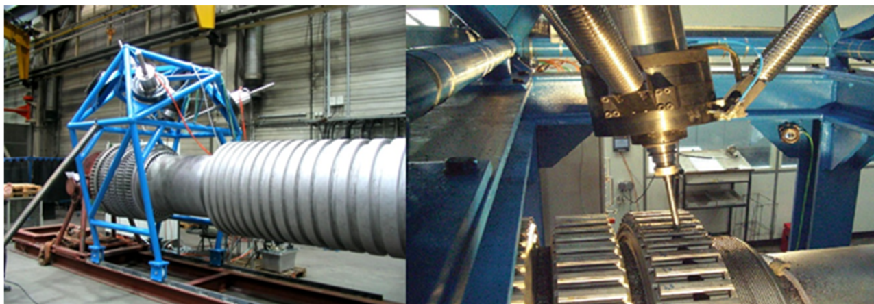
Рис. 11. Использование мобильного 5-ти осевого станка METROM для ремонта газовой турбины [50]
