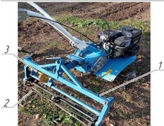
Рис. 1 – Прицепной планчато-спиральный каток:
