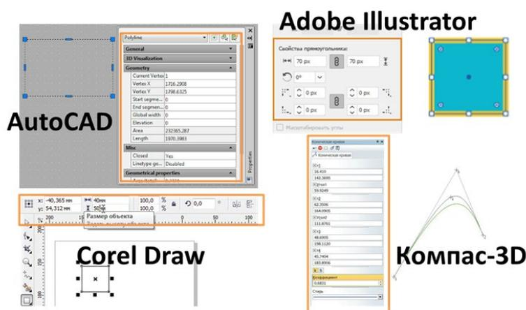
Рис. 3. Инструменты для ввода значений параметров фигур в векторных редакторах AutoCAD (© Autodesk, Inc. ), Corel Draw (© Corel Corporation ), Illustrator (© Adobe, Inc. ), Kompas-3D (© Аскон )
