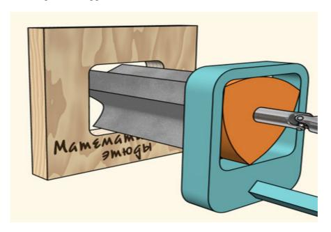
Рис. 3. Формирование квадратных отверстий сверлом Гарри Уаттса
