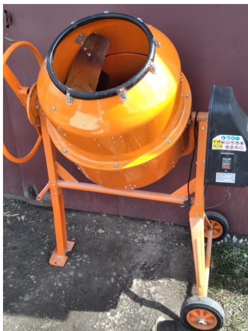
Рис. 1. Исследуемый модернизированный барабанный смеситель с Г-образными лопастями
