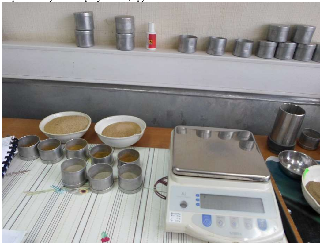
Рис. 2. Грунт с добавкой Baustab
