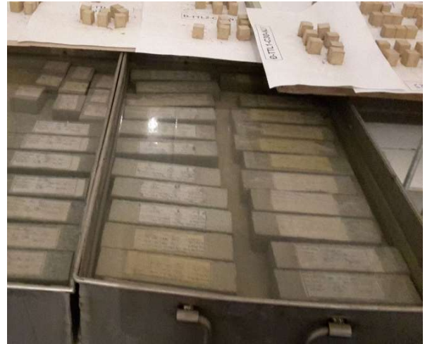
Рис. 3. Экспериментальные образцы из цементно-шлаково-песчаных растворов
