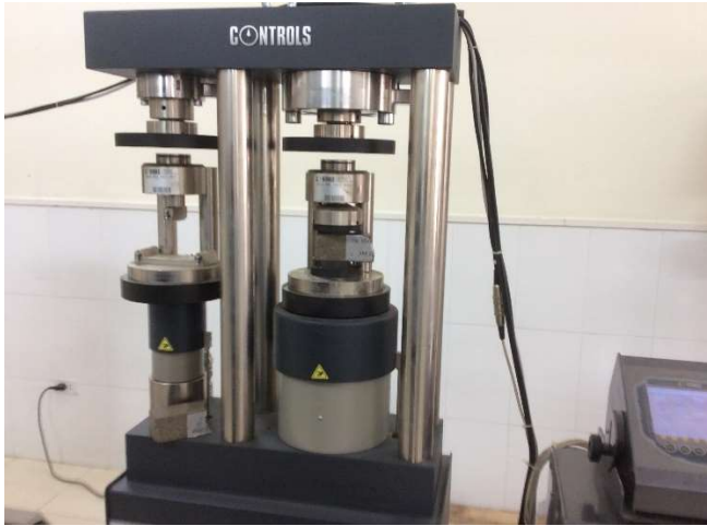
Рис. 2. Определение прочности образцов на сжатие
