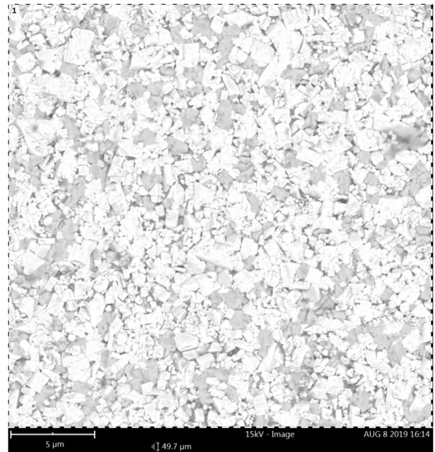
Рис. 5. Фото при локальном электронно-зондовом элементном анализе химического состава твердосплавной основы на фрагменте СМП из сплава NC3030 (Korloy, Ю. Корея)
