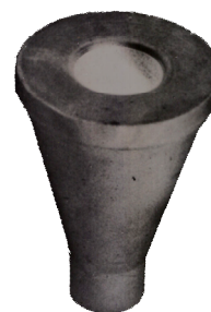
Рис. 1. Поковка, изготовленная холодным выдавливанием (материал – сталь 20 (ГОСТ 1050-74))
