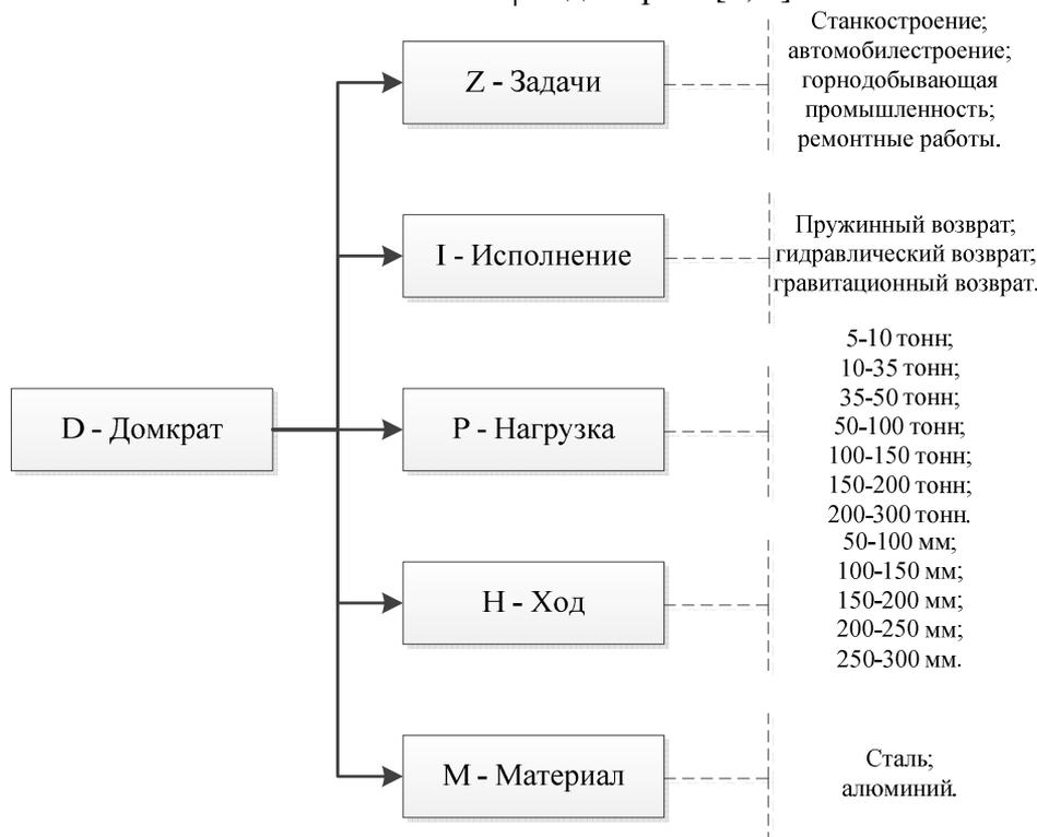
Рис. 1. Выбор домкрата в зависимости от условий его эксплуатации
