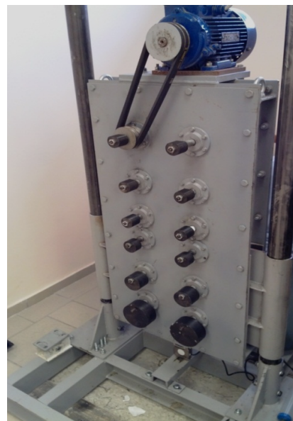
Рис. 1. Стенд для получения и исследования механических колебаний с асимметричной вынуждающей силой
