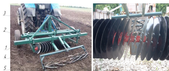
1 – рама, 2 – опорное колесо, 3 – механизм навески, 4 – рабочая секция в форме эллипсовидных дисков, 5 – ротационный каток
