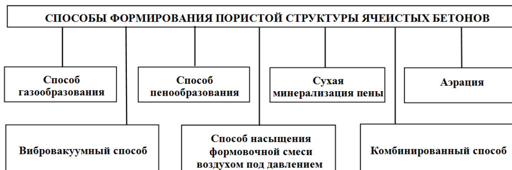
Рис. 2. Способы формирования пористой структуры ячеистых бетонов
