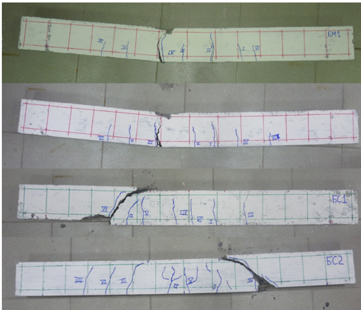
Рис. 4. Характер трещинообразования и разрушения образцов балок соответственно сверху вниз BM1, BM2, BC1 и BC2
