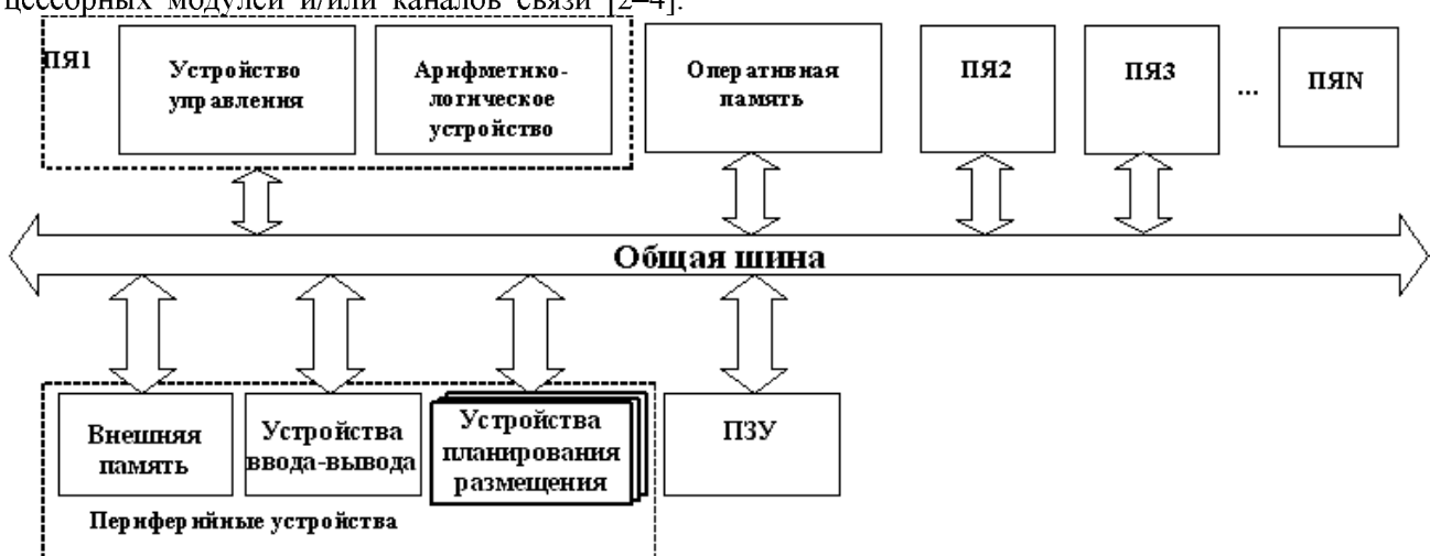
Рис. 1. Структурная схема мультипроцессорной хост-системы
