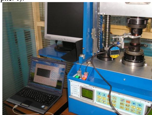
Рис. 1. Лабораторный комплекс ЛКСМ-1К с образцами мерзлого грунта
