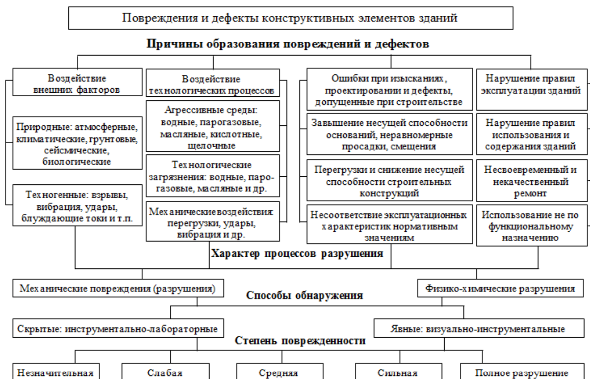
Рис. 2. Классификация повреждений и дефектов зданий
