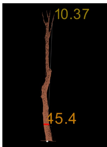
Рис. 2. Трехмерные измерительные модели отдельных деревьев в полуавтоматическом режиме
