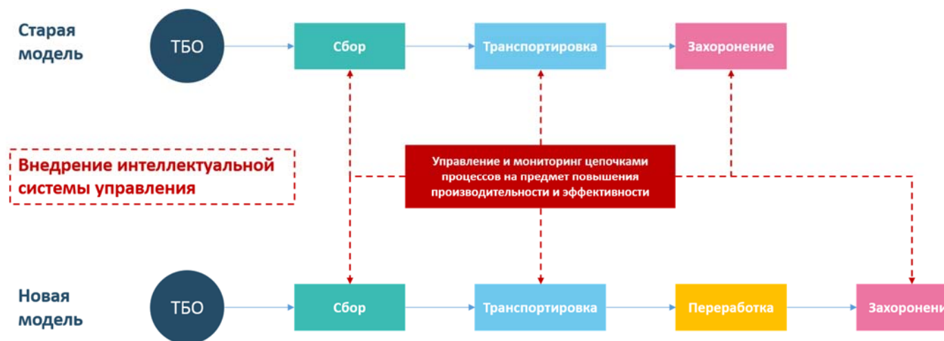
Рис. 1. Схема внедрения интеллектуальной системы управления отходами в городские процессы
