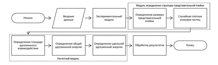
Рис. 2. Алгоритм расчета энергетических характеристик ДУПКМ
