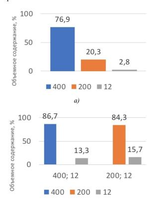
Рис. 4. Объемные соотношения фракций наполнителя для би- (a) и тридисперсных  $(\delta)$  ДУПКМ
