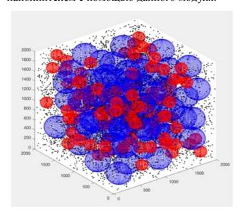
Рис. 3. Пример заполнения представительного объема полидисперсным наполнителем с помощью данного модуля
