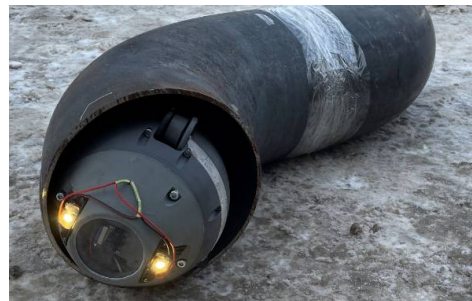
Рис. 17. Перемещение экспериментального образца ВРК на испытательном стенде
