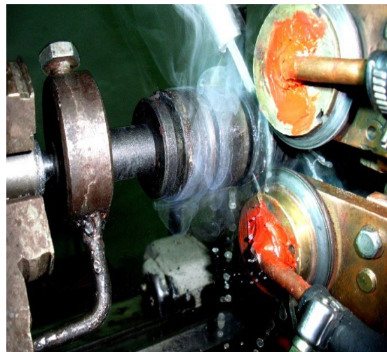
Рис. 2. Упрочнение при электромеханической обработке
