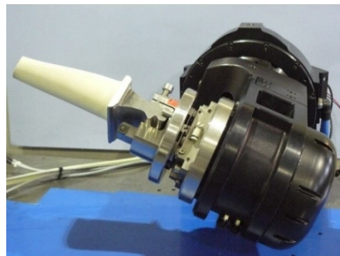
Рис. 3. Общий вид установки и разворота рабочей лопатки турбины в многоосевом поворотном приспособлении
