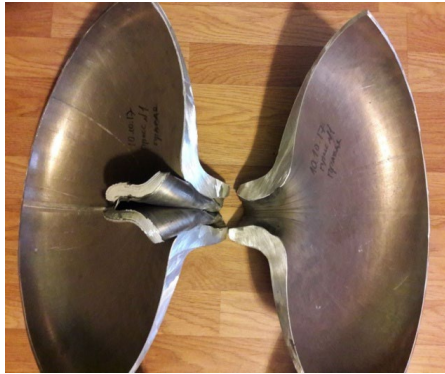
Рис. 2. Вытекание шва СТП при осадке обечайки в горячую форму
