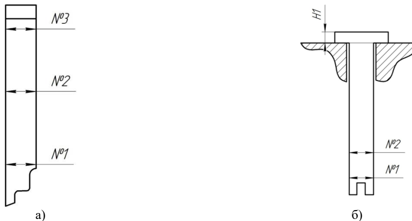
Рис. 4. Схема расположения сечений для измерения размеров пуансона: а) толщины; б) ширины и высоты заплечика
