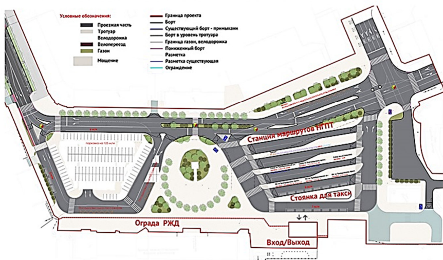
Рис. 5. Пространственное моделирование транспортно-пересадочного узла по ул. Вокзальная (вокзальная площадь). Предложения по корректировке Боровской А.Е., Смирнова А.Ю.
