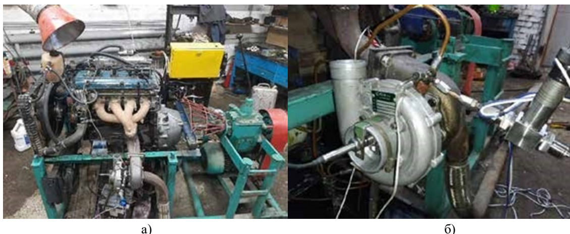
Рис. 4 – Установка 4Ч 9,2/8,0: а) полномасштабный стенд с нагрузочным устройством; б) турбокомпрессор К27-145 с присоединенными средствами контроля.
