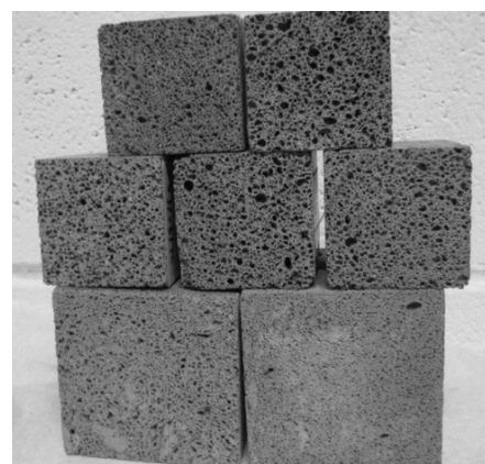
Рис. 7. Композиционный геополимерный пористый бетон: а) – показатели прочности на сжатие и плотности материала, б) – внешний вид образцов ячеистого геополимербетона [51]
