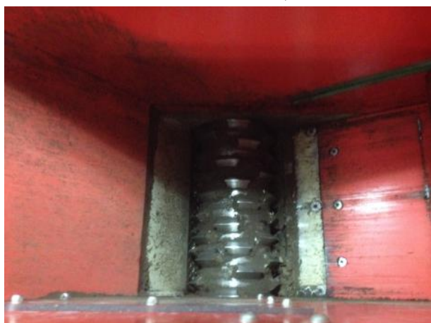
Рис. 2. Рабочий орган экспериментальной установки (измельчителя)
