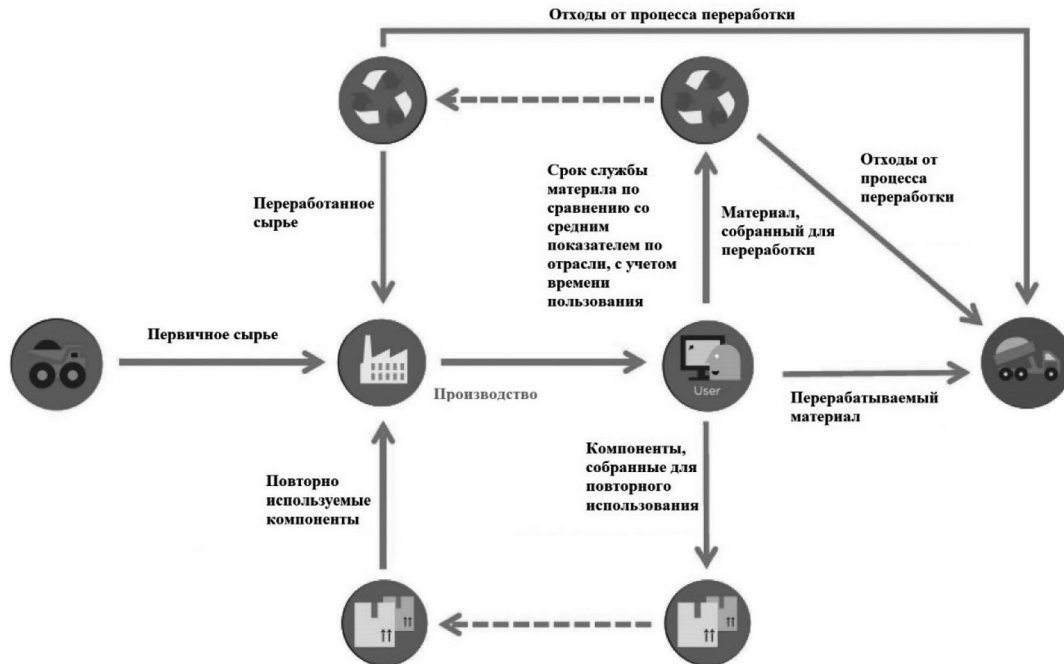
Рис. 2. Схема потока материала в соответствии рециклингом материалов [6]
